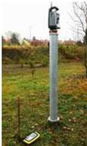
Pilí s nucenou centrací s totální stanicí a hranolem
