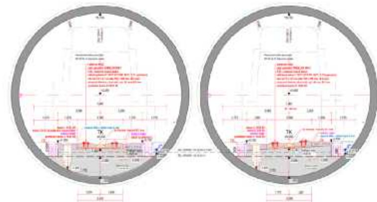
Plánový řez tunelové trouby s PJD v tunelu Ejpovice (v průměru a v oblouku)
