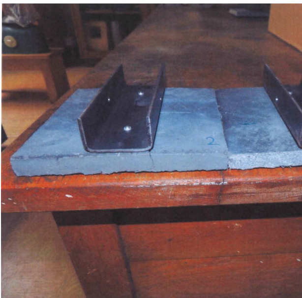
Obr.2 Porušení desek zlomením
