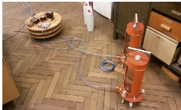
Obr. 1 Mobilní systém HYNI pro měření in-situ.
