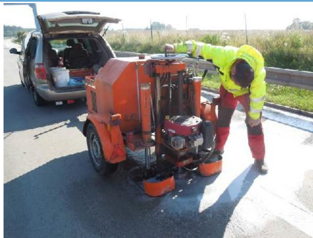
Obr. 4 Odběr vývrtů pro laboratorní rozbor.
