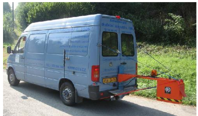
Obr. 1 Odometr osazený na kole m ícího vozidla p i m ení georadarem s anténou 1 nebo 2 GHz.
