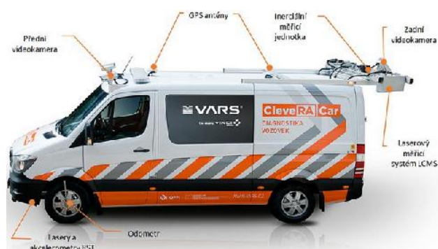
Obr. 3 Kombinace 3 lokalizačních systémů – odometr, GPS a IMU, vozidlo ClaveRA Car pro měření nerovností, textury a záznam poruch [2].
